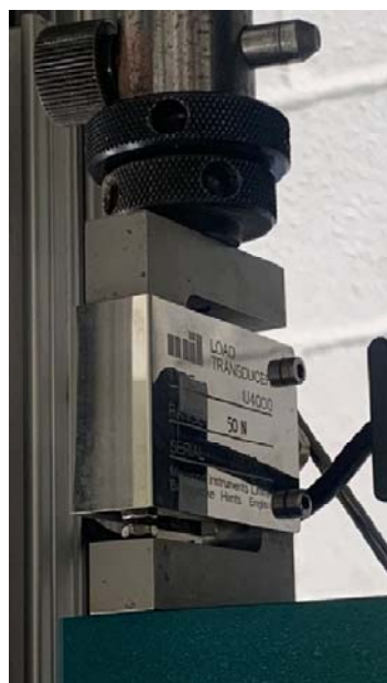
Vista do Sensor de Força
